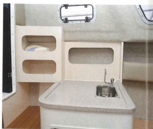
Die Pantry mit einer 15 x 30 cm messenden Druckwasserspüle kann gegen Aufpreis mit einem 42-l-Kühlschrank und einem Campingkocher komplettiert werden
