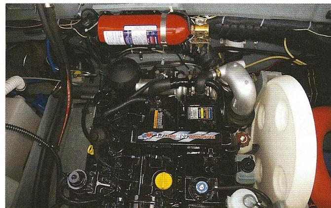
Cummins MerCruiser MS 120 mit 84,5 Diesel-kW am Propeller: Wenig kultiviert, aber sehr sparsam und enorm durchzugsstark
