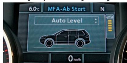
Luftfederung mit variabler Dämpfer- und Höheneinstellung
