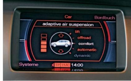
Die Charakteristik des Luftfahrwerks lässt sich mehrstufig anpassen
