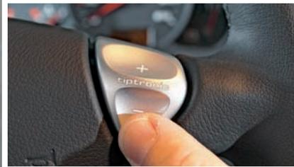
Regler für Allrad- und Fahrwerkeinstellungen, Automatik mit serienmäßigen Lenkradtasten
