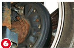
**6 TROMMELBREMSE** an der Hinterachse verschmutzt durch Abrieb und bremsen dann schlecht oder einseitig
