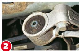
**2 SILENTLAGER** der vorderen Querlenker werden im Alter porös. Der Ersatz ist schwierig wegen der Alu-Konsole
