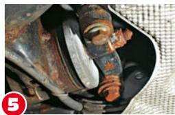
**5 BUCHSEN** der Hinterachse schlagen bei häufiger hoher Belastung aus, spürbar am Mitlenken der Hinterräder
