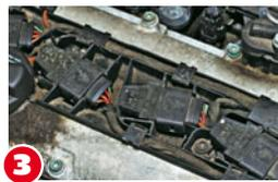
**3 ZÜNDSPULEN** sind direkt im Motor befestigt, können wegen Wärme und Vibrationen ausfallen
