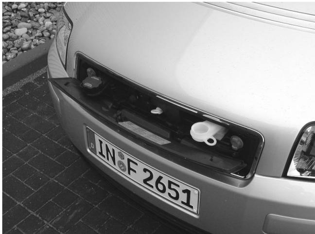
Zur Kontrolle von Wasser und Öl genügt es, die Serviceklappe zu öffnen.
